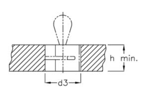
d1 = 10 d2 = 16 d3 = 16 d4 = M4 e = 2 For spring plunger = 5/6 H min = 12 I = 11.9
